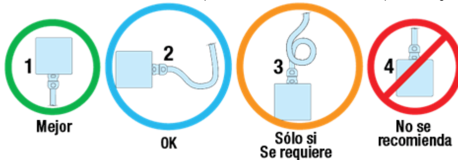
Figura 5.1: Trazado recomendado del cableado de ServoWeld.
