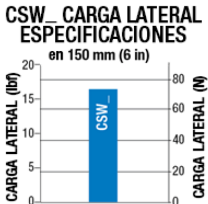
Figura 4.2: La carga lateral no debe superar los valores máximos representados por las líneas del gráfico
